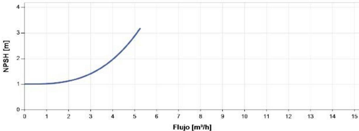
El NPSH (Net Positive Suction Head) no es la carga de aspiración cabeza operacional. Para calcular la carga de aspiración operacional, por favor vea el manual de instalación.
